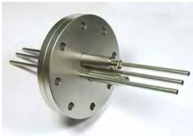
Durchführung für einen Doppelkopf-Sensor auf CF63 Flansch. Ein Rohr ist für den pneumatischen Shutter vorgesehen.
