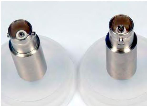
Schwierig zu unterscheiden: BNC und MHV sehen sehr ähnlich aus. Links ist BNC, rechts MHV. Der auffälligste Unterschied ist die zurückgesetzte Keramik bei der MHV Buchse.
